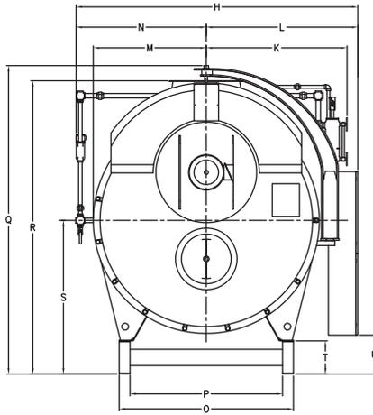
100 THRU 200 HP BOILERS USE A FRONT DOOR HINGE (NOT DAVIT AS SHOWN)
