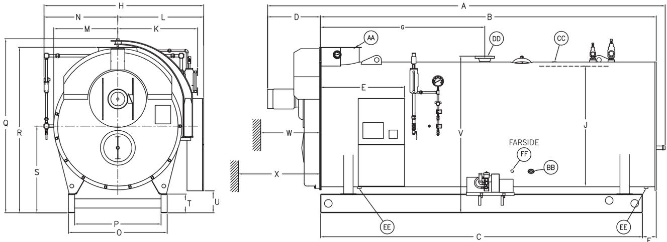
100 THRU 200 HP BOILERS USE A FRONT DOOR HINGE (NOT DAVIT AS SHOWN)
