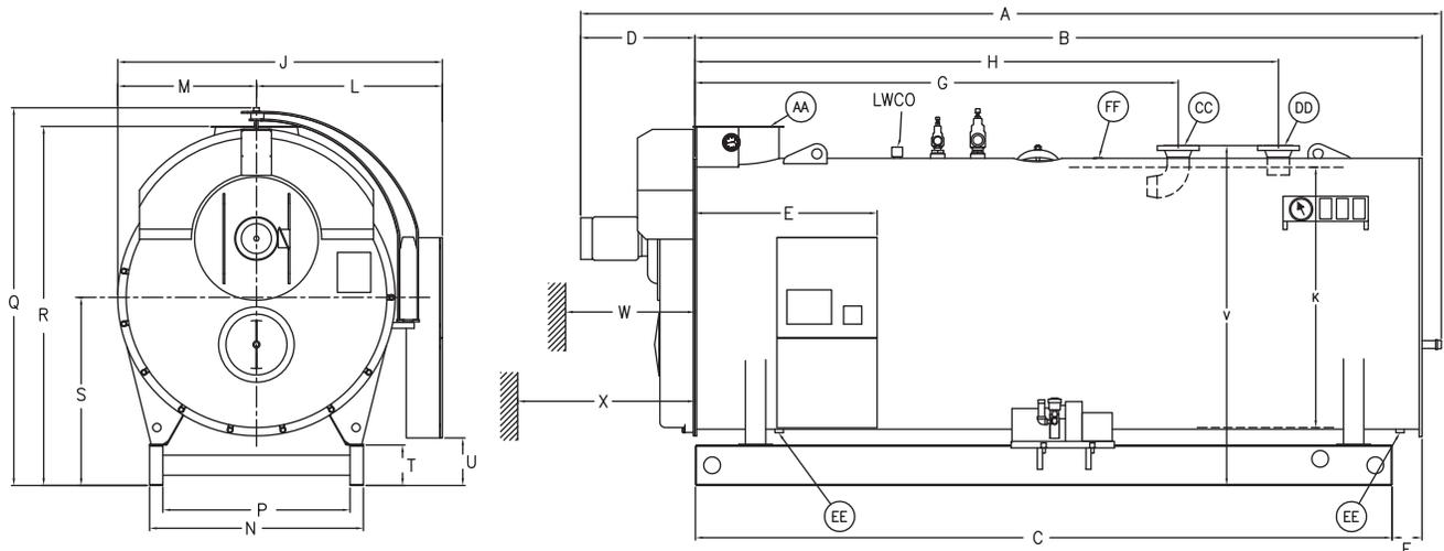
100 THRU 200 HP BOILERS USE A FRONT DOOR HINGE (NOT DAVIT AS SHOWN)
